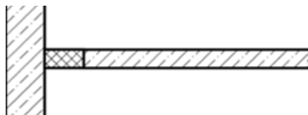
Joint horizontal en butée contre un mur
