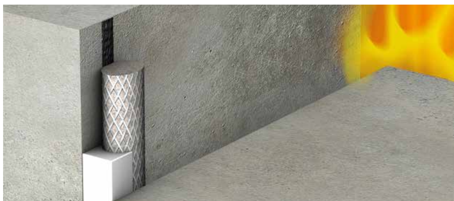
Joint horizontal en butée contre un mur
