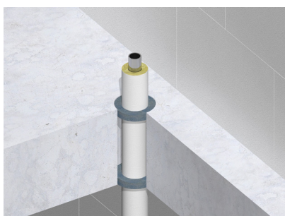
Metalen buizen voorzien van glaswol isolatie
