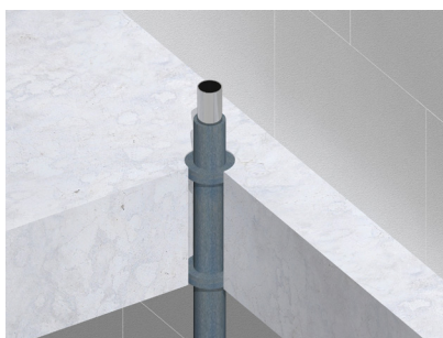
Metalen buizen voorzien van Armaflex isolatie
