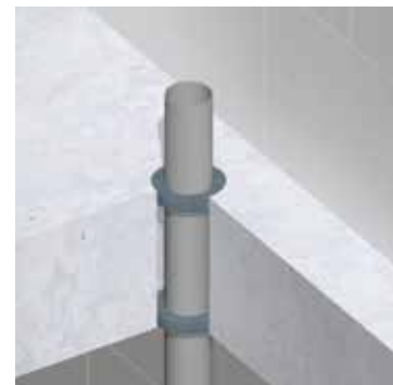
Kunststof buis tot maximaal Ø 125 mm
