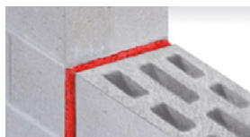
Fugen in massiven Wandkonstruktionen
