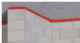
Fugen zwischen Massivwand und -decke
