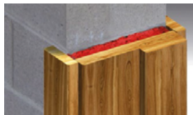
Fugen an Brandschutztüren aus Holz
