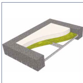
FR230 + lana mineral ignifuga + perfil perimetral para aperturas superiores de 1100mm x1100mm
