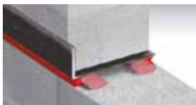
Spáry mezi stěnou a kovovým profilem
