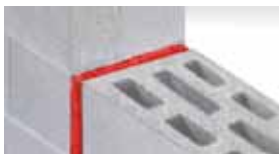
Spáry v masivní stěnové konstrukci
