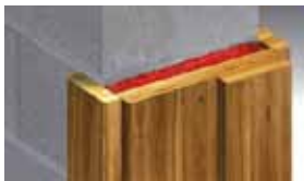
Spára mezi obložkovou zárubní požárních dveří ze dřeva.
