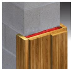
**Fugen zwischen Brandschutztür und leichter Trennwand (ebenso Mauerwerk, Porenbeton, Beton) –
